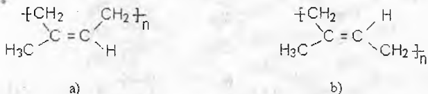
92- rasm. Tabiiy kauchuk (a) va guttapercha (b) dagi izopren zvenolarining konfiguratsiyasi: a – sis – 1,4 – poliizopren; b – trans-1,4 – poliizopren.
