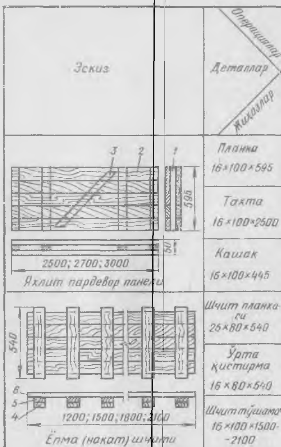
70- расм. Ёпмалар (накат) ҳамда пардевор шчитларини ишлаб чиқариш технологик процессининг тахминий схемаси
