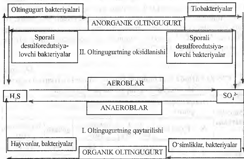
19-rasm. Oltingugurtning biogeokimyoviy aylanma harakat sxemasi.
