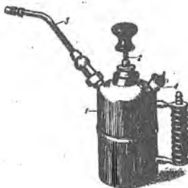
2.52-rasm. Pnevmatik dastakli purkagich «Dezinfal» ning umumiy ko‘rinishi: 1- rezervuar, 2- porshen, 3- changlatgich, 4- suyuqlik quyiladigan teshikni bekitib turadigan qalpoqcha
