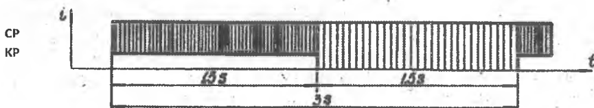
3.18-rasm. Qisqa davr (KP) - OH ko‘rinishidagi tok impulslari seriyasining DH ko‘rinishli tok impulslari seriyasi bilan almashinishi
