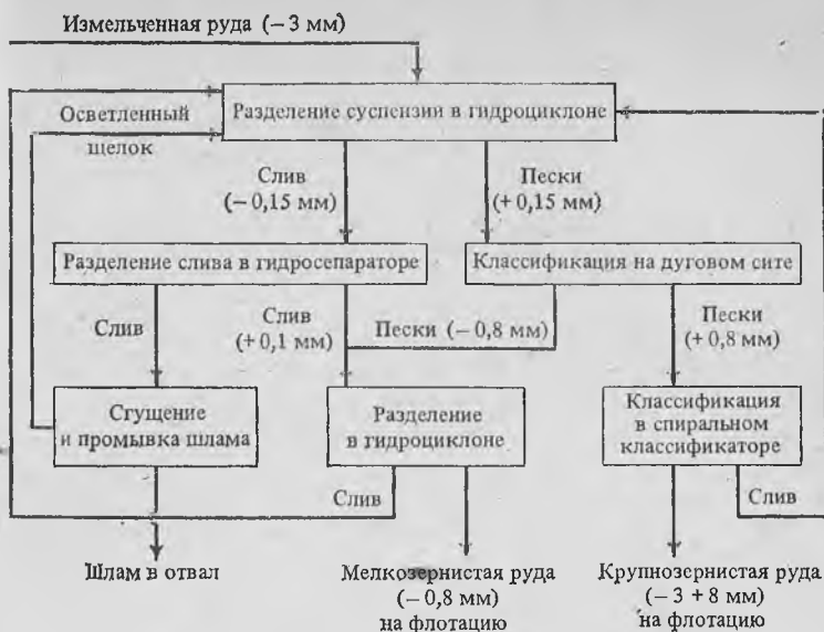
Рис. 138. Вариант схемы обесшламливания сильвинитовой руды.
