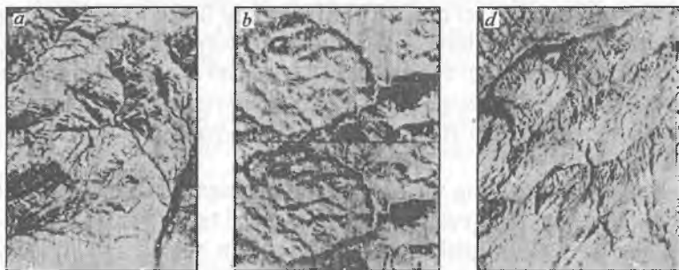
112-rasm. Intruziv tanalarning aerofotosuratlarda tasvirlanishi: a -chegaralari yaxshi aniqlanuvchi granit massivi, b -granodiorit massividagi ustki qoldiq (stereopara), d -parallel yoriqlar bilan kesilgan granitlar.
