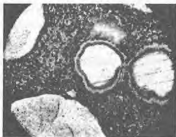
110-rasm. Bodimli teksturaga ega spilitning mikroskopik fotosurati. Zarrabinda 30 marta kattalashtirilgan.
