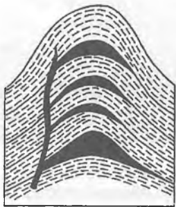
109-rasm. Antiklinal burma yadrosidagi fakolittlar (A.E.Mixaylov bo'yicha).
