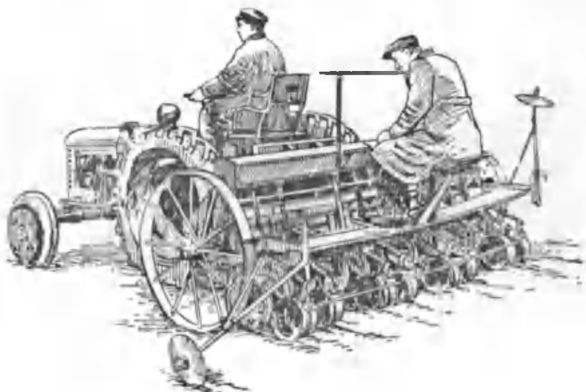
35-расм. Тракторларга тиркаладиган СОН-2,8 маркали сабзавот сеялкаси
