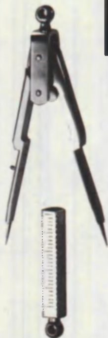
115. Jag'lar gipsli modelini o'lchagich. Tish yo'ylari kengligi va uzunligi, shuningdek tanglay chuqurligini o'lchaydigan o'lchagich.
