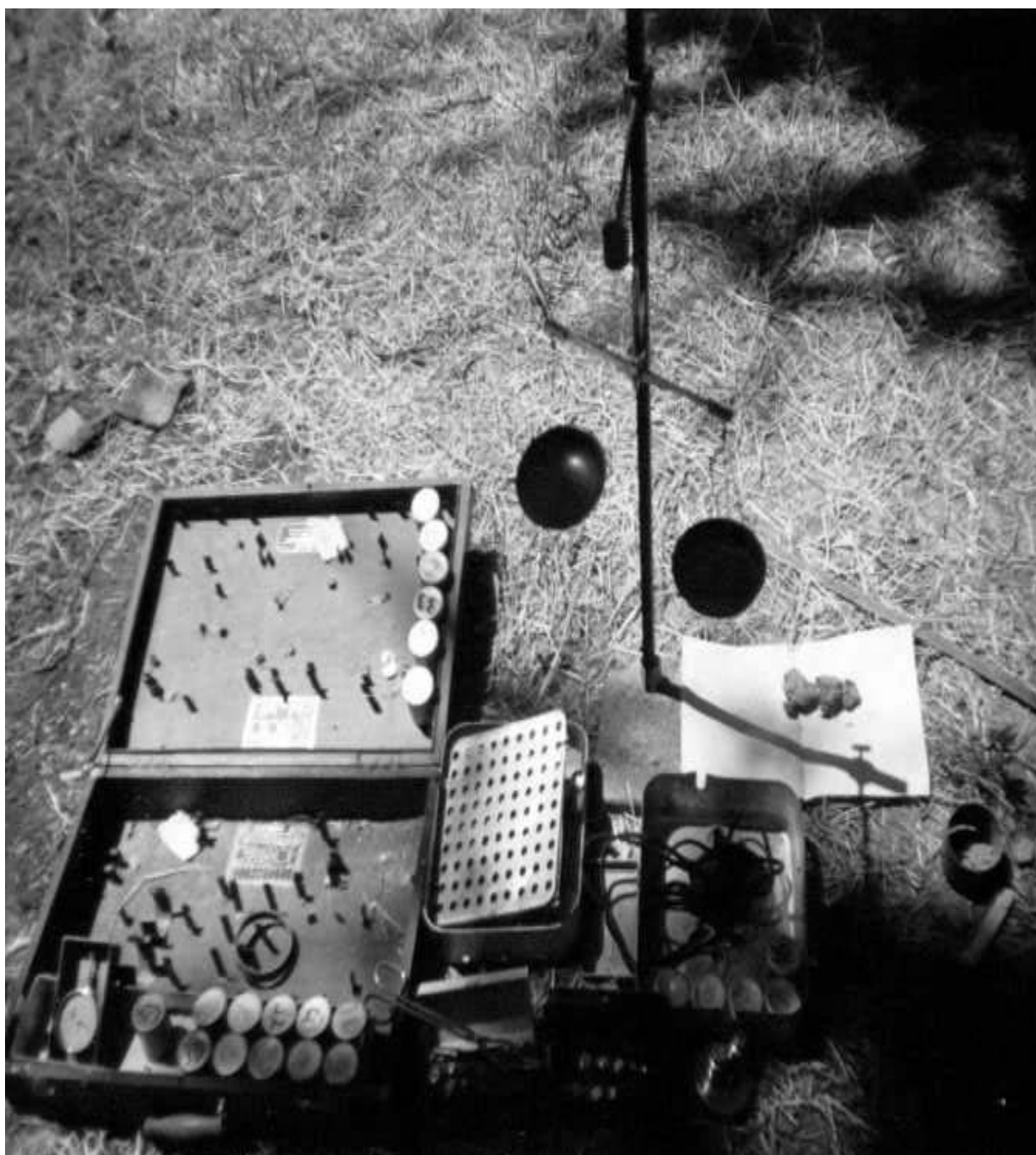
2.5-rasm. Litvinov standart qutisi va undagi asbob-anjomlar
