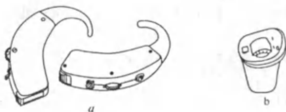
23-rasm. Eshitish apparatlarining turlari. a) quloq orti turi; b) eshituv yo'liga solinadigan turi.
