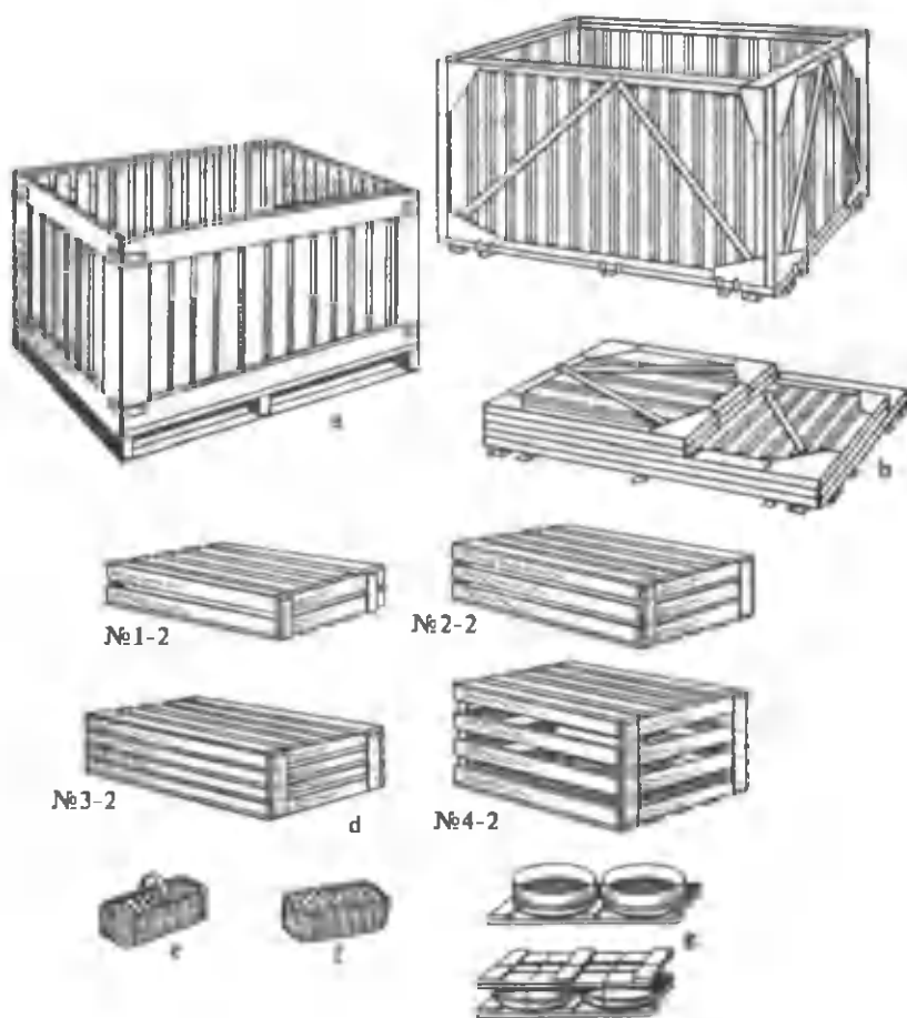
5-rasm. Meva va sabzavotlarni yig'ib olish va tashish uchun ishlatiladigan idishlar: a — yig'ilmaydigan konteyner; b — yashiklar uchun yig'iladigan taglik; d — taxta yashiklar; e — korzinalar; f — savatchalar; g — elaklar.
