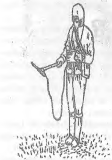
3-rasm. Zararlangan joylardagi gamma radiatsiya darajasini DP-5V asbobi yordamida aniqlash
