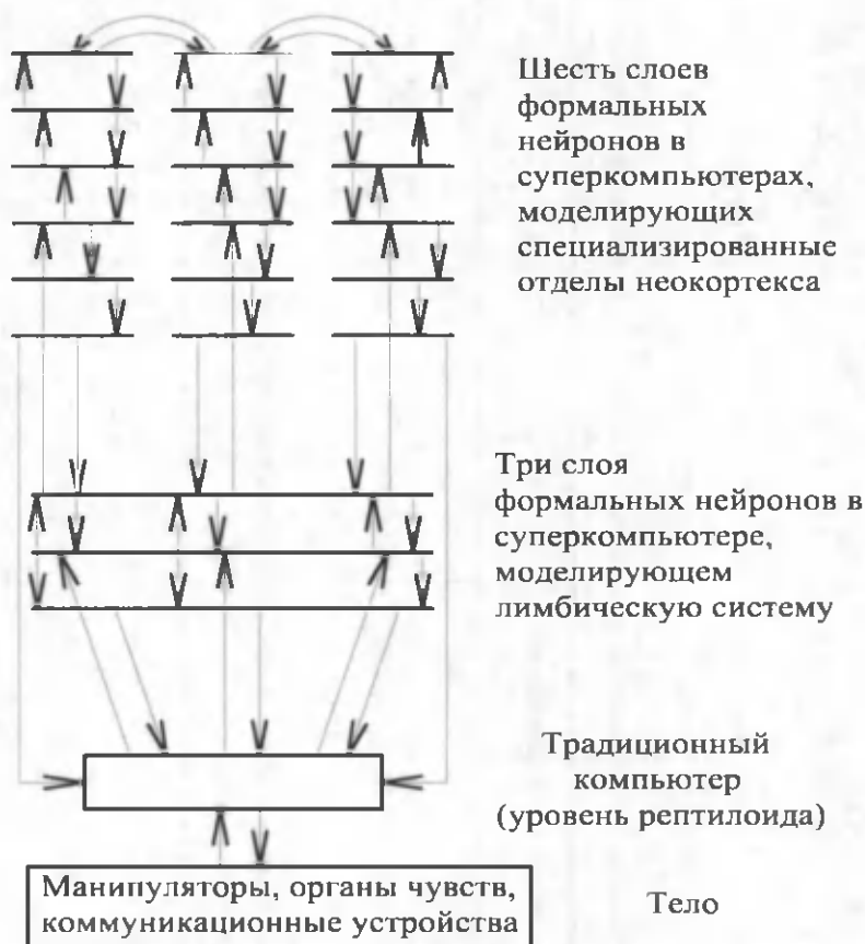
Рисунок 51. Вариант конструктивно и программно заданных соединений между слоями формальных нейронов в неокортексе и лимбической системе и между суперкомпьютерами, моделирующими специализированные отделы неокортекса и суперкомпьютером - лимбической системой.
