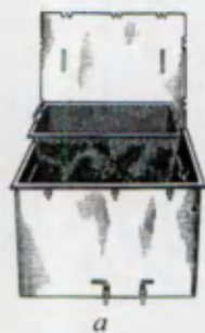
66-расм. Кағиз ҳажмидаги мумкатак рамкаларни жойлаштириб мум олишга мўлжалланган бугли мум эриткич: а – бугли мум эриткичнинг умумий кўрилиши; б – мум эриткичнинг тузилиши:
