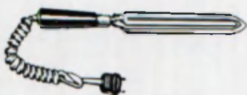
58-расм. Асал устидаги мумпарлани қирқадиган электр пичок.
