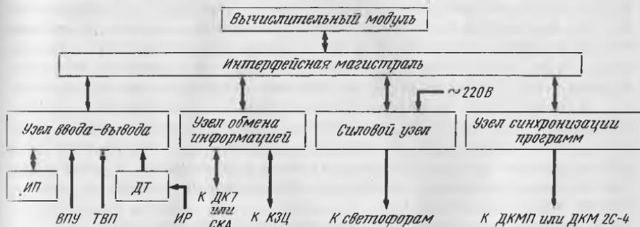
Рис. 4.6. Структурная схема контроллера ДКМП:
