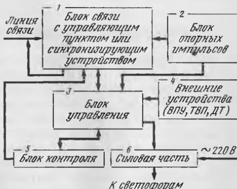
Рис. 4.1. Обобщенная структурная схема контроллера:
