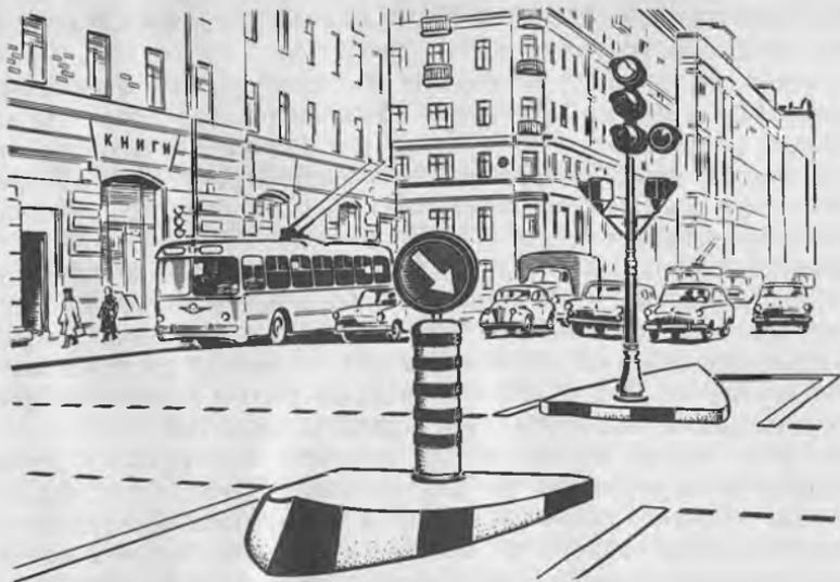
Рис. 10.3. Оборудование островка безопасности
