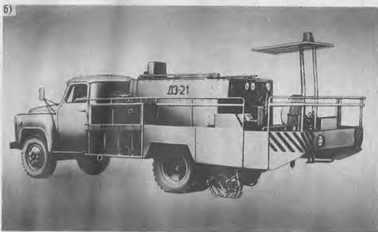
Рис. 9.9. Машина ДЭ-21 для нанесения линий разметки:
