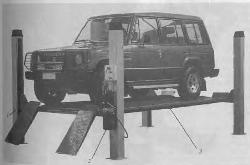
**Рис. 11.24.** Подъемник электромеханический четырехстоечный площадочный
