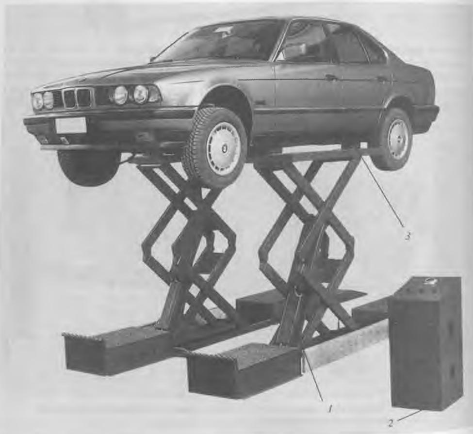
**Рис. 11.25.** Подъемник гидравлический в ножничном исполнении
