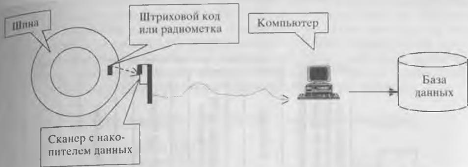
Рис. 18.4. Принципиальная схема автоматизации управления ресурсом шин на базе средств автоматической идентификации объектов
