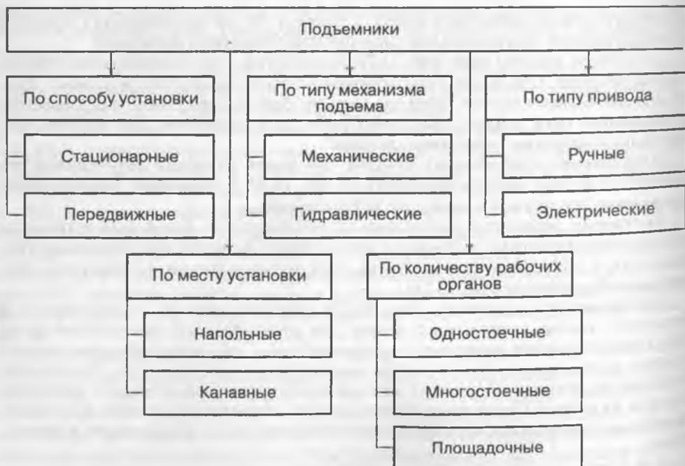
Рис. 11.22. Классификация подъемников
