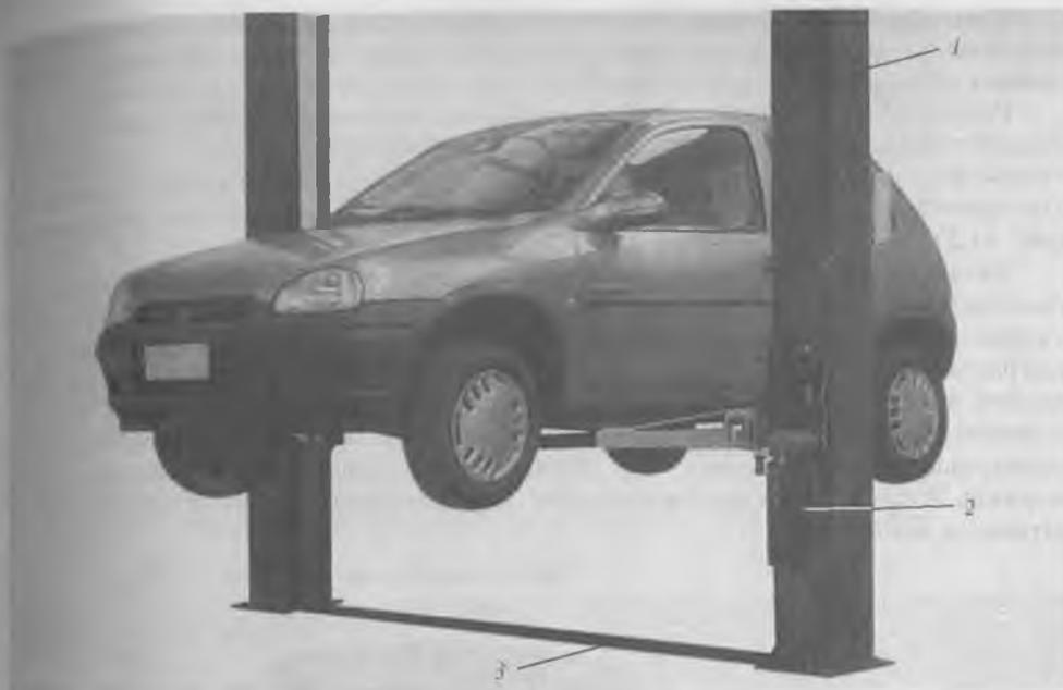
**Рис. 11.23.** Подъемник электромеханический двухстоечный
