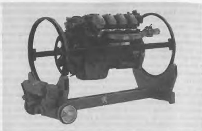
Рис. 11.19. Стенд для разборки-сборки двигателей
