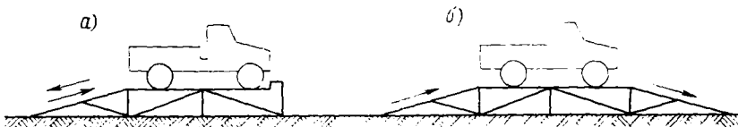
Рис. 8.4. Схема устройства эстакад: а — тупиковая; б — прямоточная
