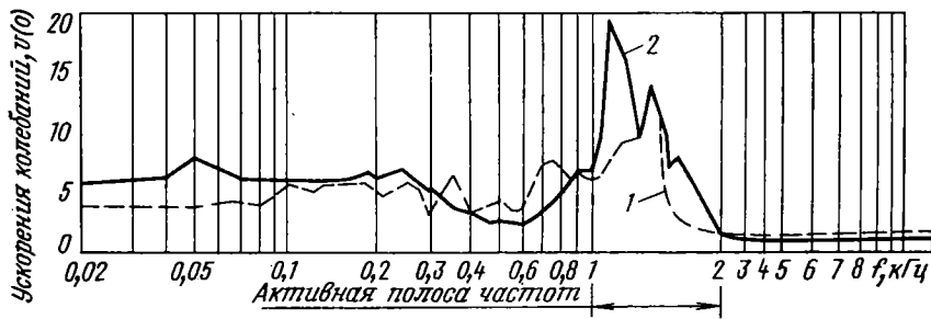
Рис. 6.45. Частотный спектр ускорения колебаний v блока цилиндров двигателя ГАЗ-51 при 1200 об/мин и зазоре в подшипнике: 1 — 0,066 мм; 2 — 0,326 мм
