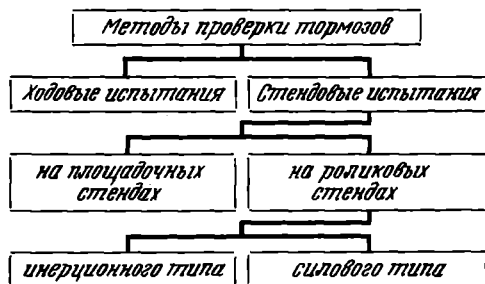
Рис. 8.20. Классификация методов проверки тормозов автомобилей
