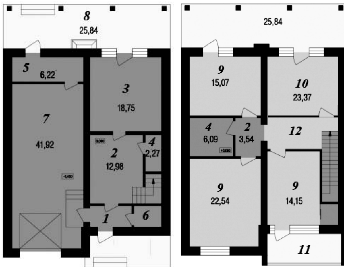
4.6-rasm. Bloklashtirilgan turdagi turar-joy binolarining tarzlari va tarhlari 1-tambur; 2-dahliz; 3-oshxona; 4-sanitariya-gigiegna bo'limi; 5-omborxonasi; 6-shkaf; 7-avtolov garaj; 8-ravon ayvon; 9-yotoqxonasi; 10-umumiy xona; 11-osma ayvon; 12-yo'lak;
