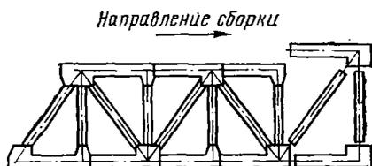
Рис. 26.1. Схема расположения элементов (монтажных марок) главных ферм после укрупнительной сборки. Фасонки и накладки закрепляются к пердним по ходу сборки концам элементов поясов
