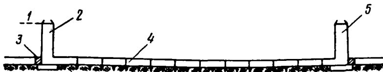
Рис. 81. Схема проверки коллектора на водонепроницаемость:
