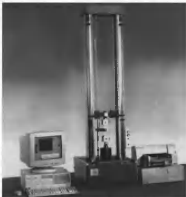
13.8-расм. Полимерларнинг механик хоссаларини аниқлашда ишлатиладиган асбоб.
