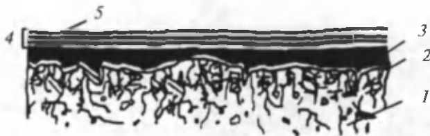
4.1-расм. Юзага суртилган лок-бўёқ қатламлари: 1 - юза; 2 - хомаки бўёқ қатлами; 3 - шпатлёвка; 4 - бир неча қатлам суртилган лок-бўёқ; 5 - муҳит таъсирига кўра танланган сиртқи қатлам.
