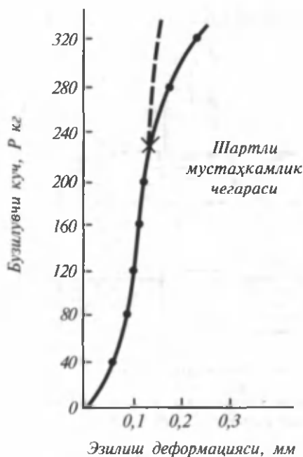
9.8-расм. Ёғочнинг толаларига қундаланг тушган кучнинг эзилиш деформацияси.
