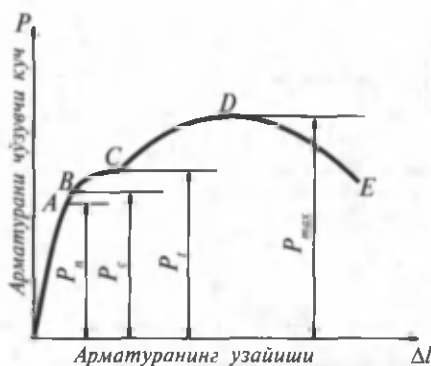
8.5-расм. Кам углеродли пўлатнинг чўзилиш диаграммаси.
