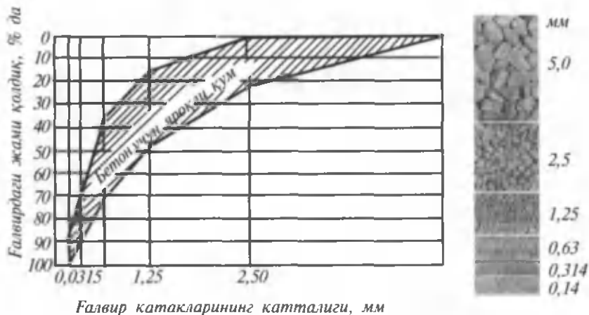
5.4-расм. Қумни бетон ёки қоришма учун яроқли эквалитини унинг майда-йирикликгига қараб аниқлаш графиги.
