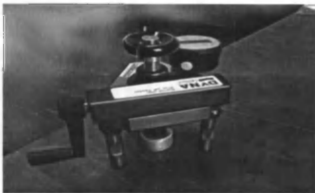
2.10 -расм. Адгезион мустаҳкамликни аниқловчи асбоб.
