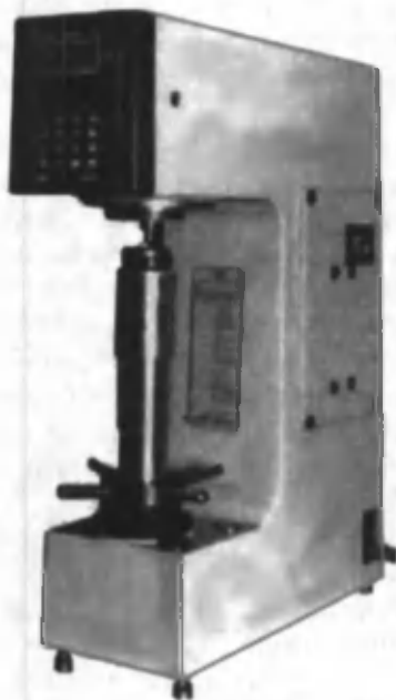
13.3-расм. Қурилиш ашёларининг қаттиқлигини Роквелли усулида тестер билан аниқлаш асбоби.
