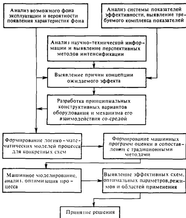
Рис. III.23. Блок-схема использования логико-математических моделей описаний для оценки эффективности новых методов воздействия на грунт
