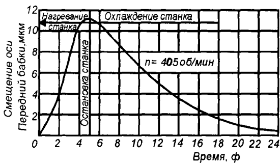
2.4-расм. Токарлик дастгоҳининг марказларида ишлов беришда олдинги бабканинг қизиши натижасида ўқининг горизонтал йўналиш бўйича силжиши
