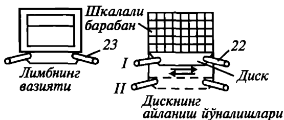
277-расм. 1К62 станогн суриш қутиси панелида дасталарнинг жойлашиш схемаси:
