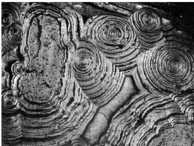
Рис. 6.15. Структура пироуглеродной матрицы углерод-углеродного композиционного материала [31]
