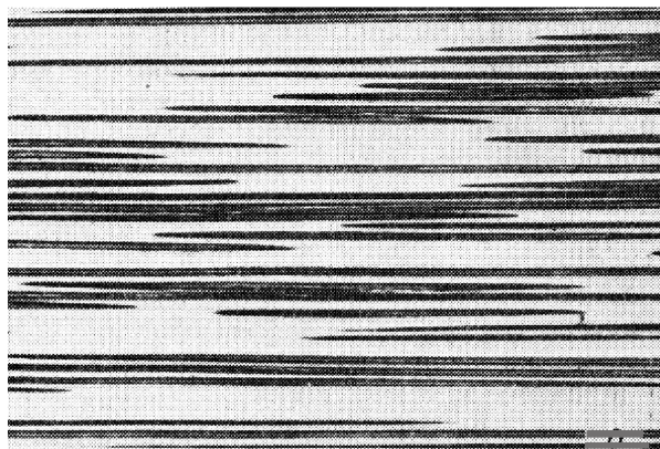
Рис. 4.46. Микроструктура эвтектики MnSb-Sb в поперечном (а) и продольном (б) сечениях [21]
