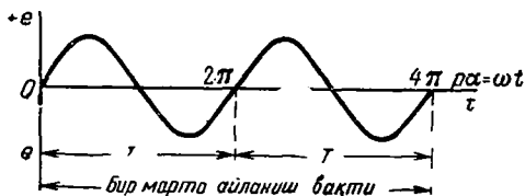
5-5- расм. Икки жуфт қутбли генератор ўзгарувчан э. ю. к. нинг графиги.
