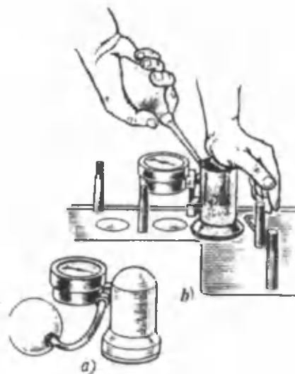
34.8-chizma. Klapanlarni ishqalab moslashtirish sifatini tekshirish uchun asbob (a) va uning ishlatilishi (b).
