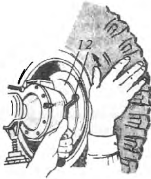
12.5- расм. Тормоз колодкалари қопламаси ва барабан орасидаги тирқишни созлаш.
