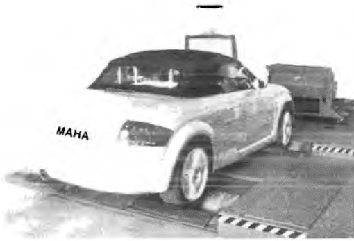
3.18- расм. LPS русумли тортиш стени (ишлаб чиқарувчи МАНА Maschinenbau Haldenwang GmbH&CO.KG).
