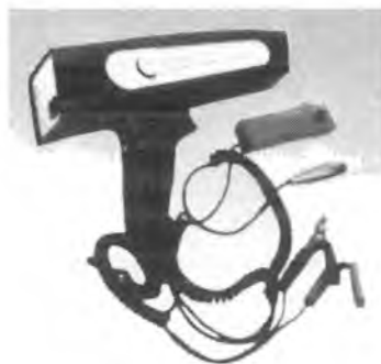
10.3- расм. Бензинда ишловчи двигателларнинг ўт олдириш тизимини назорат қилувчи рақамли стробоскоп (DA-3100 русумли).
