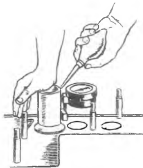
7.12- расм. Клапаннинг тозаланиш сифатини текшириш.
