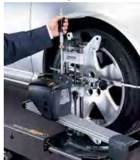
3.33-расм. Hofmann Werkstatt-Technir GmbH компанияси томонидан ишлаб чиқарилган Geoliner 770 русумли бошқарилувчан ғилдиракларни ўрнатиш бурчакларини ўлчаш станди а)стенднинг умумий кўриниши; б)ғилдиракка ўрнатиладиган нишон; в)Hunter Engineering Company компанияси томонидан ишлаб чиқарилган пружиналар чўкишини ўлчагич
