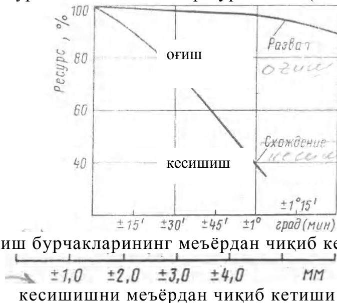
22.6-расм. Оғиш ва яқинлашув бурчакларининг шина ресурсига таъсири
