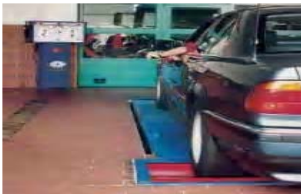
13-расм. IW 2 WB русумли енгил автомобиллар тормоз тизимларини текширувчи куч роликли стенди
