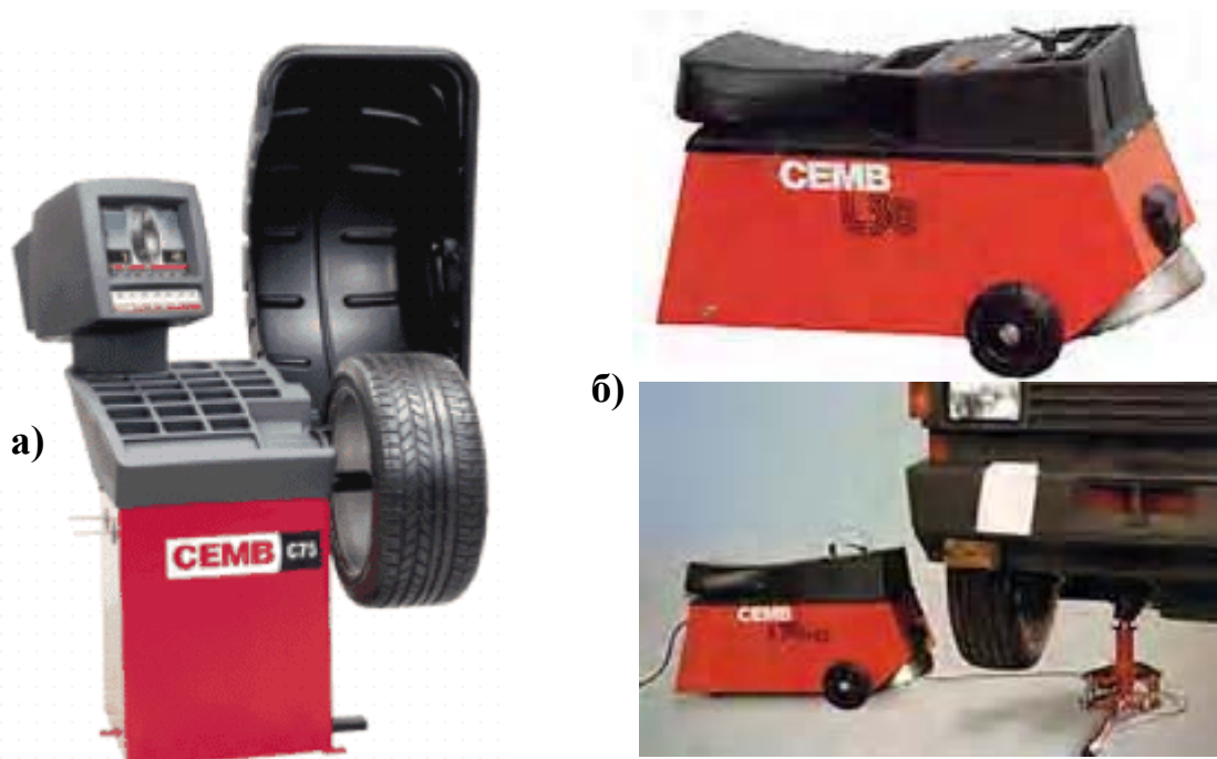
3.31-расм. SEMB компанияси мувозанатлаш стендлари: а) С-75 русумли электрон мувозанатлаш стенди; б) автомобилда охирги мувозанатлаш стенди
