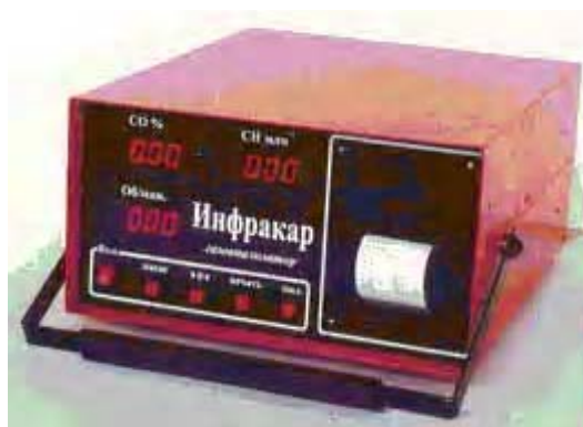
3.21-расм. «ИНФРАКАР 10.02» газ анализатори (ўлчаш чегаралари: 0...10% CO, 0...5000 ppm CH, 0...10000 айл/мин)
