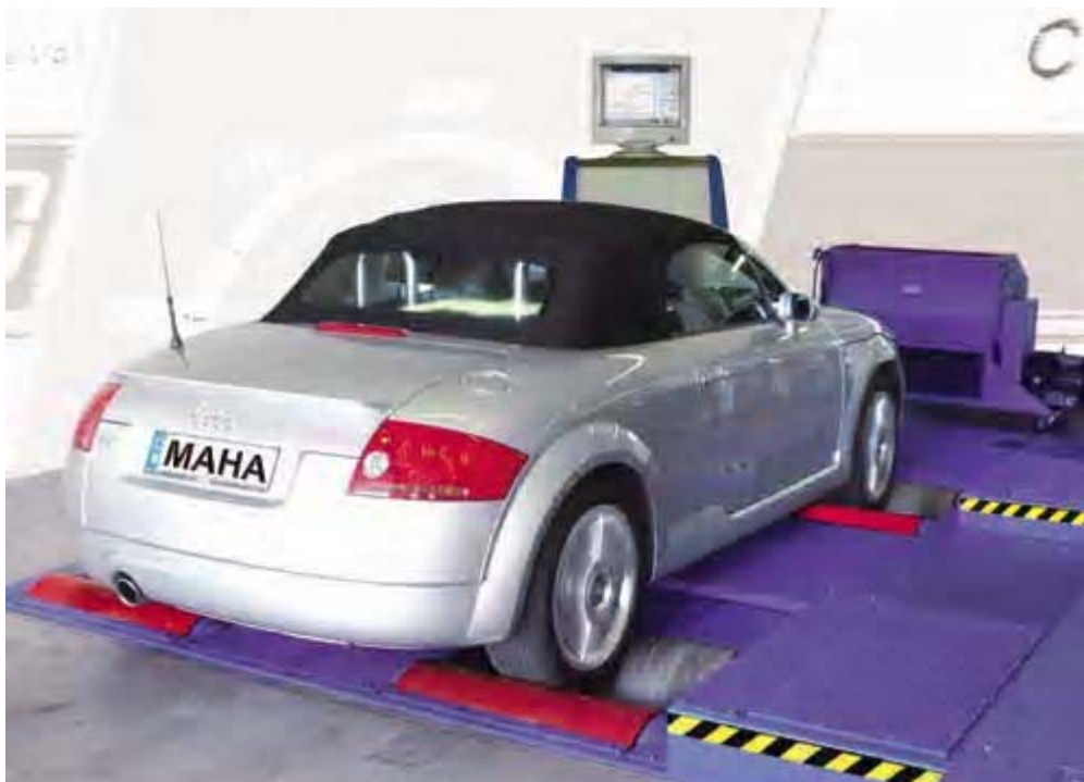
3.18-расм. LPS русумли тортиш стенди (ишлаб чиқарувчи МАНА Maschinenbau Haldenwang GmbH&CO.KG)
