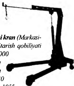
12-rasm. Transmissiya agregatlari uchun harakatlanuvchi ustun (marka-5.1206, yuk ko'tarish qobiliyati 600 kg, ko'tarib olish balandligi 1125 mm, ko'tarish balandligi 1950 mm, tashqi o'lchamlar 375x305x112 mm, massasi 49 kg.)
