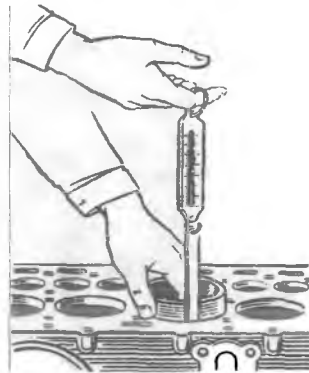
55-rasm. Porshen va silindr orasidagi tirqishni tekshirish shakli
