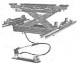
10-rasm. Ko'rish ariqchasi uchun gidravlik domkrat
