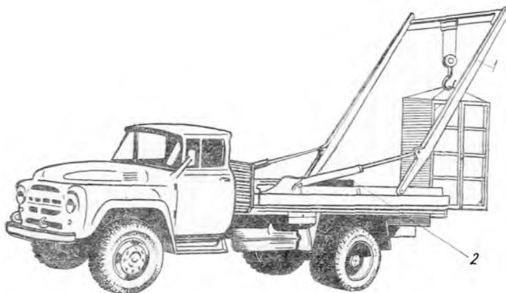
Рис. 8.12. Автомобиль с порталным краном
