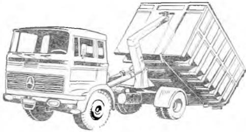
Рис. 8.15. Самосвальный съемный кузов фирмы Meiller на шасси автомобиля Mercedes-Benz
