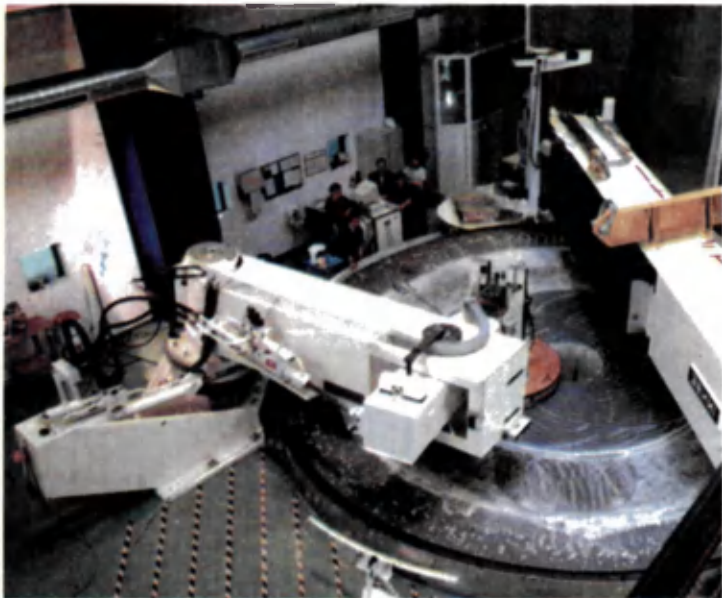
56- rasm. Diametri 8 metrli teleskop ko'zgisiga sexda sayqal berish jarayoni.
