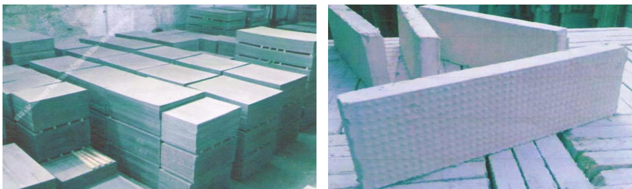
14.5 – расм. Асбестоцементли иссиқ сақловчи текис варақлар (а) ва девор панеллари (б)
