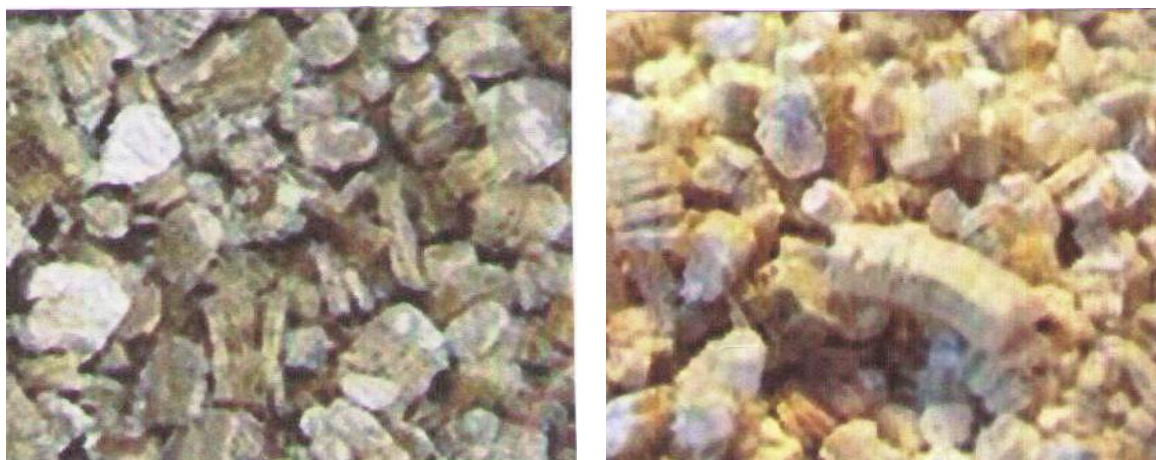
14.3 – расм. Иссиқ сақловчи буюмлар олиш учун қўлланиладиган шиширилган перлит (а) ва вермикулит (б)
