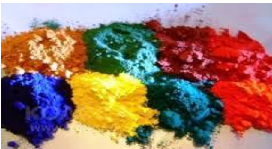
12.3 - расм. Рангли асфалтбетонлар учун ишлатиладиган пигментлар
