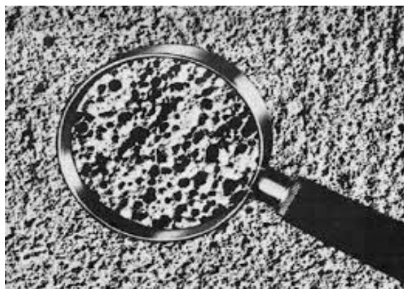
8.7 - расм. Ғоваклаштирилган енгил бетон тузлишининг микроскопда кўриниши
