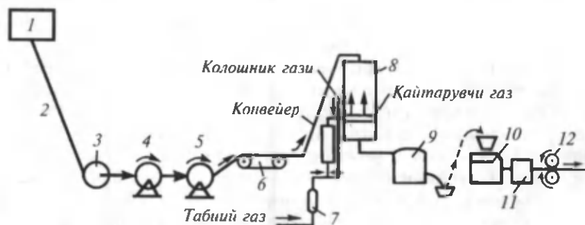
18-расм. Темир рудалардан пўлатни домнасиз олиш усулининг технологик схемаси:
