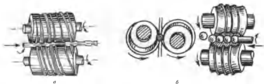
101-расм. Кўндалангига прокатлаш: шатуи поковкасини (а) ва шарларни даврий прокатлаш (б)
