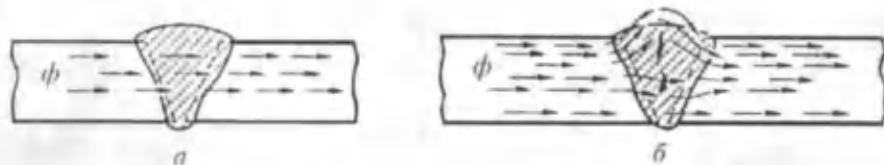
234-расм. Буюмда магнит оқимининг тарқалиши: a — пайвандчок нуқсонсиз; b — пайванд чокда дарз бор
