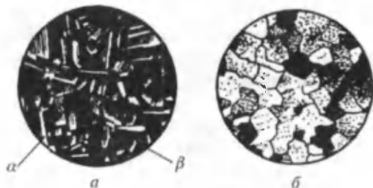
58-расм. Юмшатишган латунь (а) ва бронза (б)ларнинг микроструктураси.
