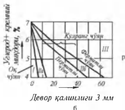
11-расм, а ва в. Углерод, кремний ва девор қалинлигининг чўян турига таъсир этиш графиги
