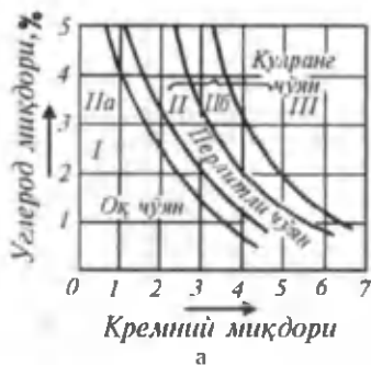
11-расм, а ва в. Углерод, кремний ва девор қалинлигининг чўян турига таъсир этиш графиги
