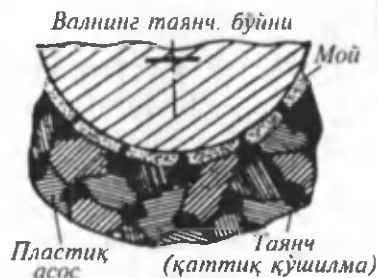
59-расм. Сирпаниш подшипнигининг ишлаш схемаси.
