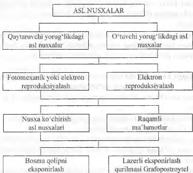
2.1-rasm. Trafaret bosma bosishgacha bo'lgan jarayonlarning texnologik shakli
