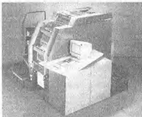
4.7-rasm. Heidelberg firmasining DI QM 46-4 raqamli bosma uskunasi
