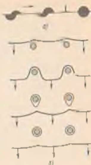
Рис. 81. Модель движения дислокации в дисперсно-твердых сплавах:
