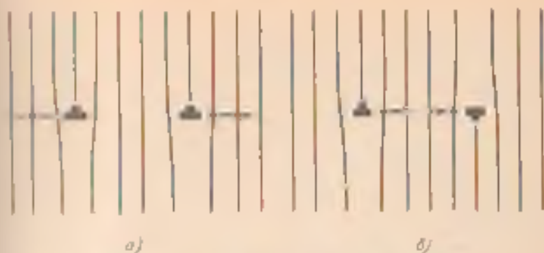
Рис. 12. Схема взаимодействия дислокаций, лежащих в одной плоскости скольжения
