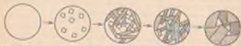
Рис. 237. Схема кристаллизации стекла при образовании оталки с помощью нуклеатора
