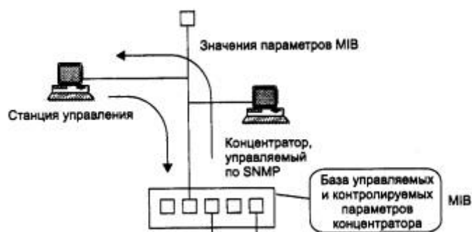
Рис. 4.11. Структура системы управления на основе протокола SNMP
