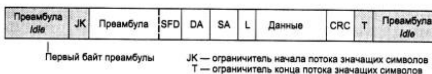
Рис. 3.22. Непрерывный поток данных спецификаций 100Base-FX/TX
