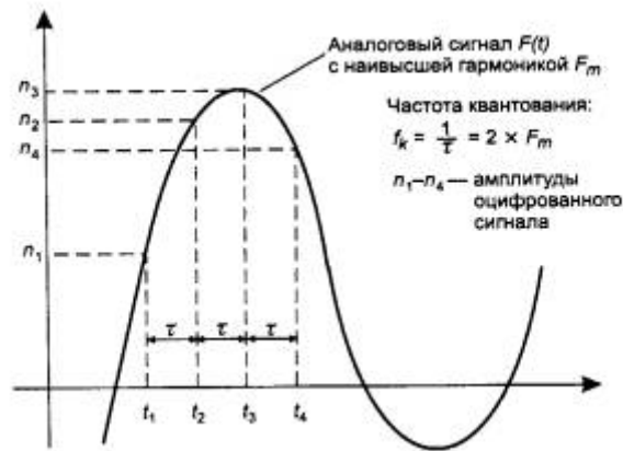
Рис. 2.19. Дискретная модуляция непрерывного процесса
