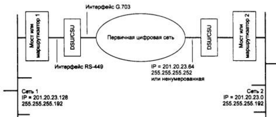
Рис. 6.14. Соединение сетей с помощью выделенного канала
