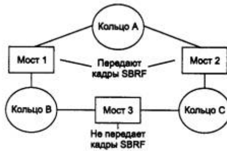
Рис. 4.21. Мосты типа Source Routing
