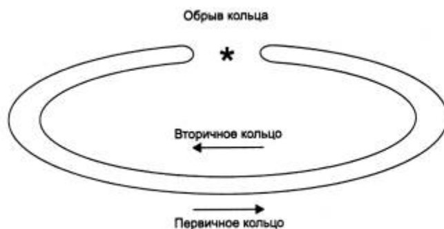
Рис. 3.16. Реконфигурация колец FDDI при отказе
