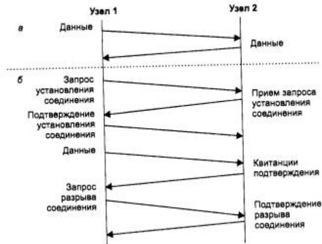
Рис. 2.23. Протоколы без установления соединения (а) и с установлением соединения (б)
