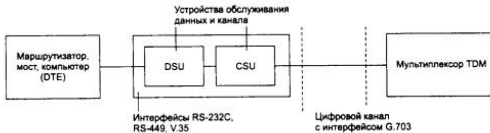
Рис. 6.12. Использование DSU/CSU для подключения к цифровой выделенной линии
