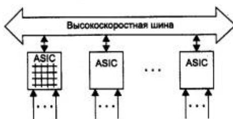
Рис. 4.35. Комбинирование архитектур коммутационной матрицы и общей шины
