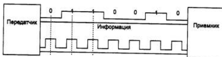
Рис. 2.15. Синхронизация приемника и передатчика на небольших расстояниях
