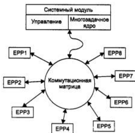
Рис. 4.23. Структура коммутатора EtherSwitch компании Kalpana
