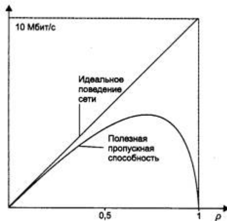
Рис. 4.15. Зависимость полезной пропускной способности сети Ethernet от коэффициента использования
