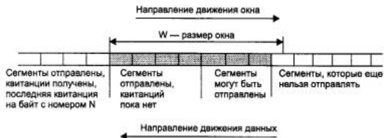
Рис. 5.24. Особенности реализации алгоритма скользящего окна в протоколе TCP
