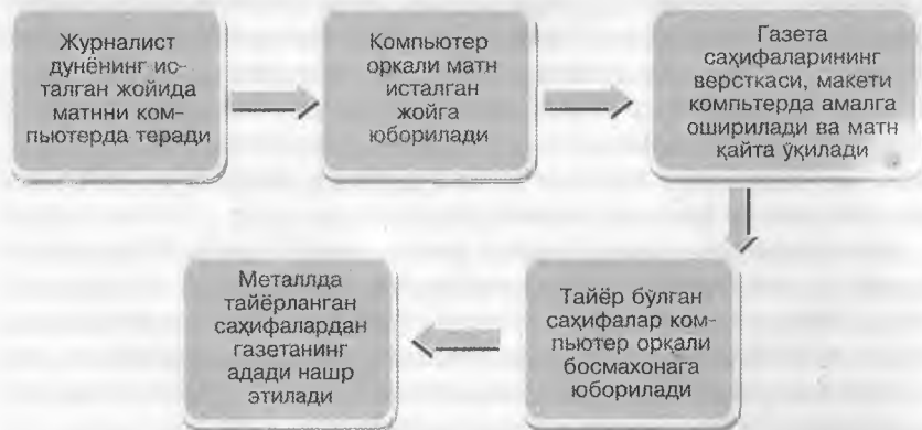
2-расм. Компьютер технологияларига асосланган газета ишлаб чиқариш жараёни.
