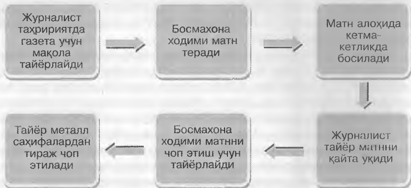
1-расм. Газетани компьютерлаштириш жараёнига қадар мавжуд бўлган ишлаб чиқариш технологияси.
