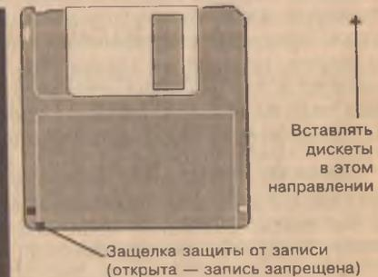
Рис. 2.5. Дискета размером 3,5 дюйма (89 мм)
