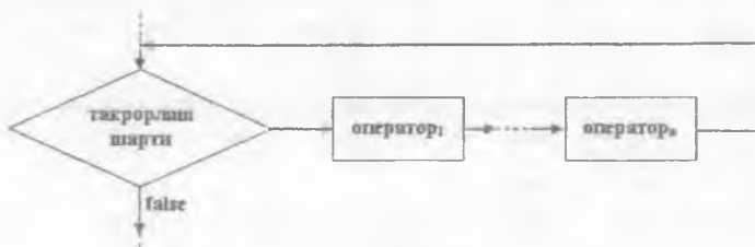
4.2-расм. Такрорлаш операторининг блок схемаси
