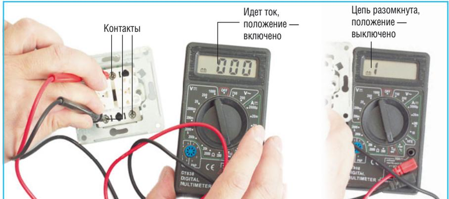
**4** Находим общий выводной контакт для двухклавишного выключателя (для одноклавишного достаточно проверить направление включения). Парно проверяем контакты с помощью мультиметра в режиме прозвонки. Данный вывод должен замыкаться и размыкаться с другими двумя выводами при переключении клавиш выключателя.
