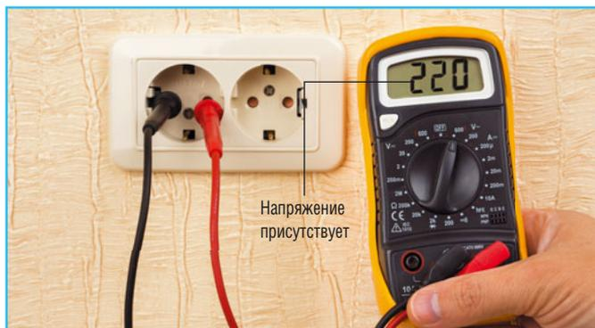
**Проверьте работоспособность мультиметра** (или индикаторной отвертки) на работающем оборудовании: вставьте в розетку — появятся цифры 220 или засветится неоновая лампочка.
