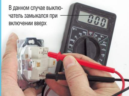
**3** Прозваниваем выключатель. При замыкании прибор должен показывать нули, при размыкании — единицу. Так мы можем определить ориентацию выключателя. Чаще всего включение делают при нажатии на верхнюю часть клавиши выключателя.
