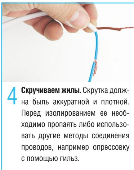
**4** Скручиваем жилы. Скрутка должна быть аккуратной и плотной. Перед изолированием ее необходимо пропаять либо использовать другие методы соединения проводов, например опрессовку с помощью гильз.
