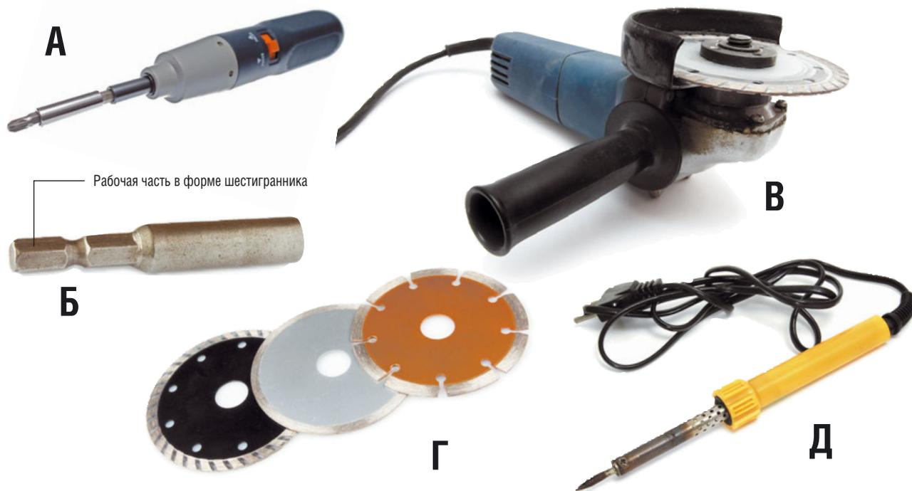
односкоростным и двухскоростным. Последний удобен тем, что в одном режиме используется в качестве шуруповерта (скорость вращения шпинделя — 400 об/мин), а в другом — дрели (скорость — 800–1300 об/мин). Кроме того, шуруповерт имеет регулятор крутящего момента, чтобы с необходимой силой закручивать шурупы без риска сорвать шляпку крепежа.
