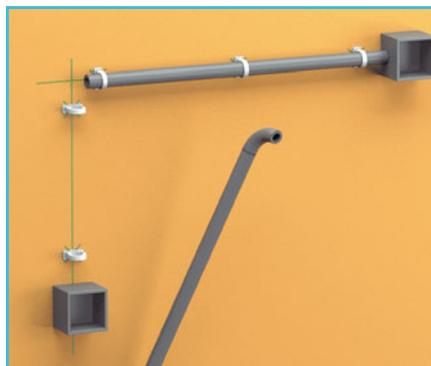
**5** Разрезаем трубы ножовкой по металлу на куски нужной длины, а затем укрепляем их в клипсах, подгоняя размеры аксессуаров.
