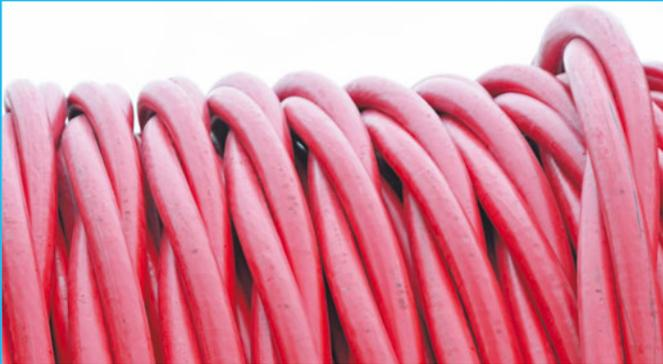
**Силиконовая резина** — весьма эластичный термостойкий изолятор, при сгорании образует диэлектрическую защитную пленку.
