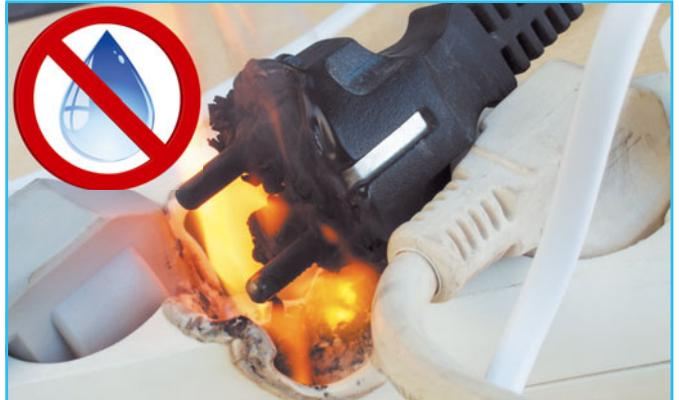
Если в бытовом приборе или проводке возникает очаг возгорания, **нельзя тушить его водой**, поскольку она хороший проводник электричества и вы рискуете получить заряд тока через струю воды.
