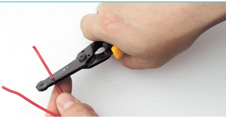
**1 Зачищаем провод** на расстояние 3–4 см для проводов сечением 1,5–2,5 мм<sup>2</sup>. Для проводов большего сечения следует сделать зачистку на большую длину.
