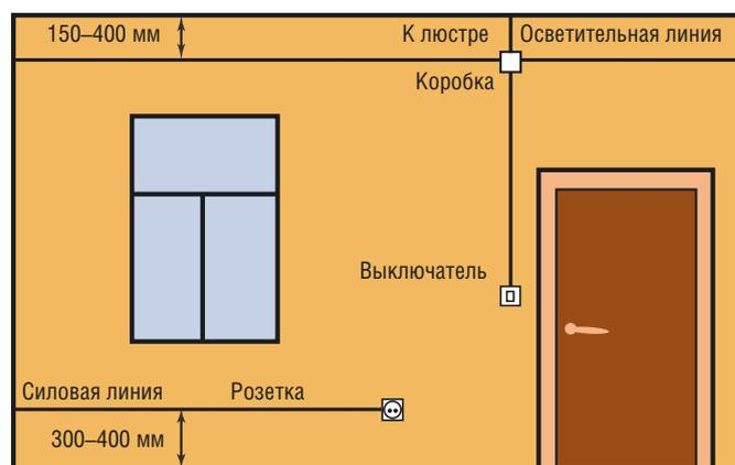
Силовые кабели и провода освещения подключены к щитку отдельно
