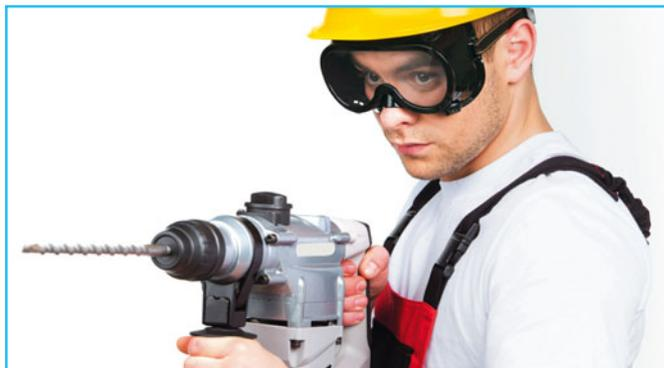
При работе с инструментом **используйте средства защиты глаз** (очки для защиты глаз от отлетающих кусочков обрабатываемого материала, респиратор для защиты легких от пыли).
