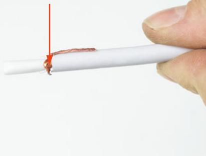
**3 Удаляем фольгу** и скручиваем жилы экрана.
