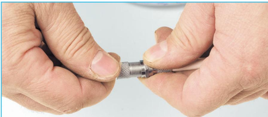
**8 Накручиваем вторую часть** антенного штекера. Следим, чтобы центральный провод попал в специальное отверстие. В противном случае штекер не будет работать.
