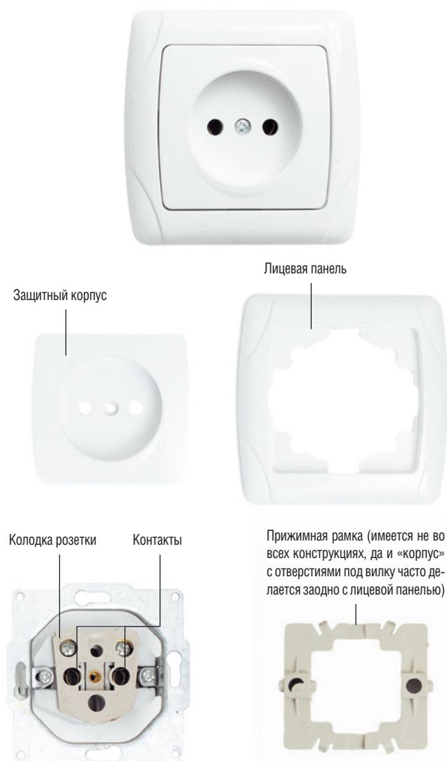
**Контакт** — основной рабочий элемент розетки. Через него энергия от силового кабеля передается в подключаемый прибор. Материал контакта — металлический сплав, который обладает определенной упругостью для надежного соединения штырьков вилки с розеткой. С одной стороны контакты оборудованы винтовыми или клавишными зажимами для подключения к силовому проводнику, с другой — взаимодействуют с вилкой.
