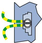
Приваривание к предварительно очищенному участку трубы
