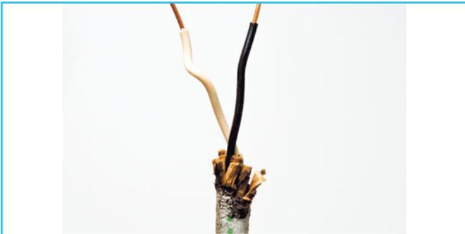
**Не допускайте эксплуатации кабелей** с устаревшей изоляцией. Не забывайте регулярно убеждаться в исправности проводов и кабелей, а также проводить время от времени профилактические замеры реального сопротивления вашей изоляции.
