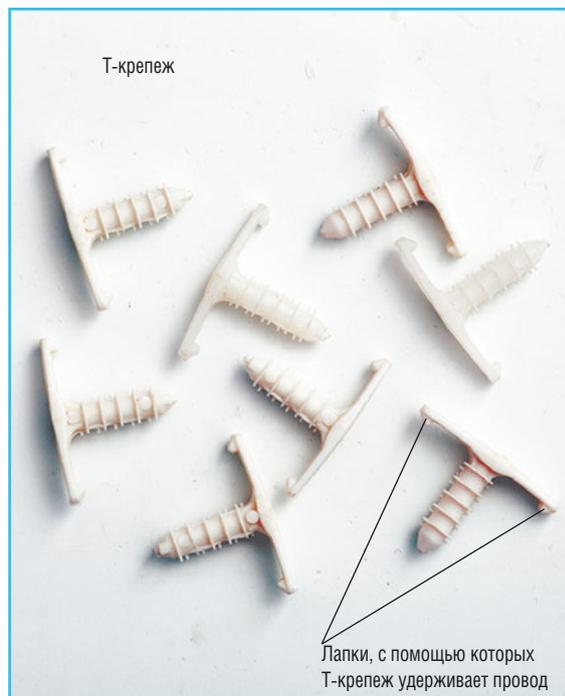
Для наружной прокладки провода вдоль стены также используют Т-крепеж. Перфоратором просверливают отверстия, вбивают туда Т-крепеж и под его лапки заводят кабель.
