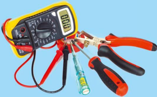
Тщательно **проверьте на исправность** инструменты, с которыми собираетесь работать: отвертки, пассатижи и др. Изоляция ручки отвертки или пассатижей не должна иметь механических повреждений: небольшая трещина может обернуться электрическим ударом.
