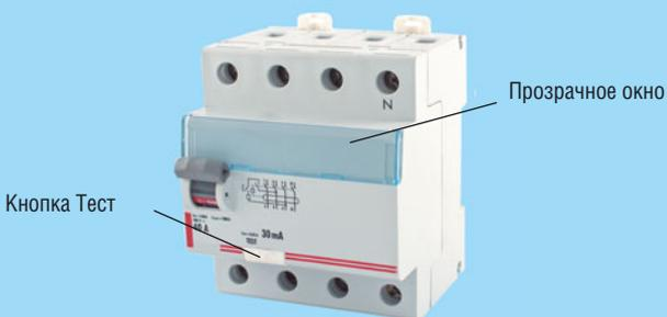
Чтобы удостовериться в исправности УЗО, следует нажать кнопку Тест. Она имитирует утечку тока. Если УЗО исправно, то при нажатии кнопки прибор непременно сработает (отщелкнется); если изменений не произойдет, значит, он не функционирует либо неправильно подключен.
