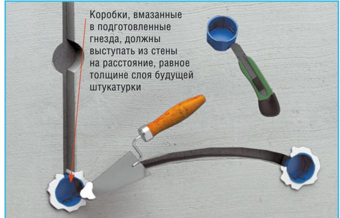
Коробки, вмозанные в подготовленные гнезда, должны выступать из стены на расстояние, равное толщине слоя будущей штукатурки
