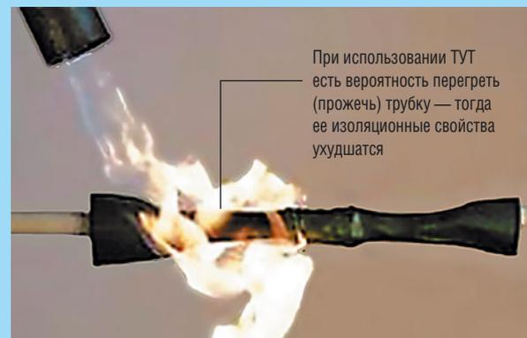
При использовании ТУТ есть вероятность перегреть (прожечь) трубку — тогда ее изоляционные свойства ухудшатся
