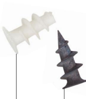
**Ввертыши** (иногда их называют дюбелями для гипсокартона), с их помощью к гипсокартону крепятся светильники и другие электроустановочные изделия. Для этого сверлят отверстие, а потом вкручивают в него крепеж. Некоторые ввертыши могут сами под себя делать отверстия
