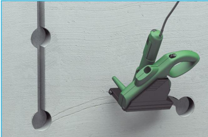
**2 Пробиваем** в стенах перфоратором проходные отверстия под розетки и выключатели, а затем штроборезом или болгаркой делаем штробы между ними.
