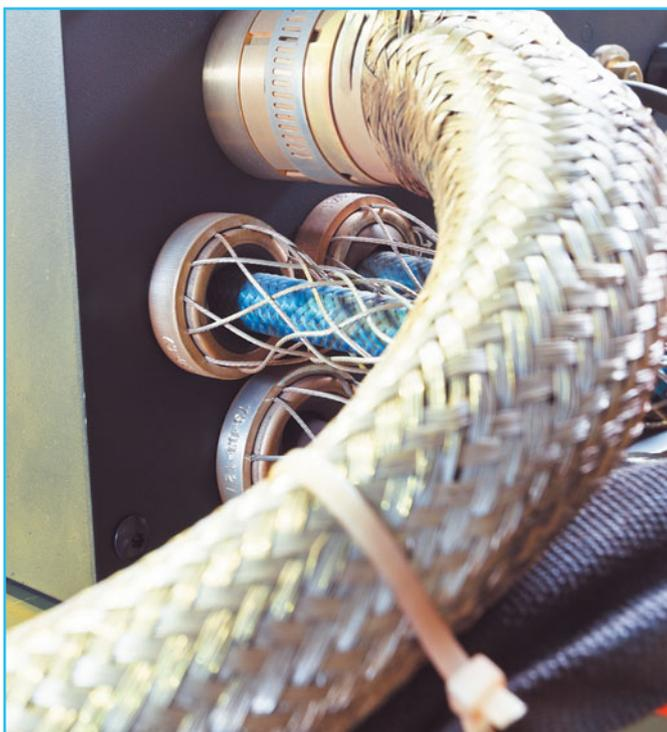
Существует и дополнительная изоляция проводов в виде оплетки из **стальной оцинкованной проволоки**.
