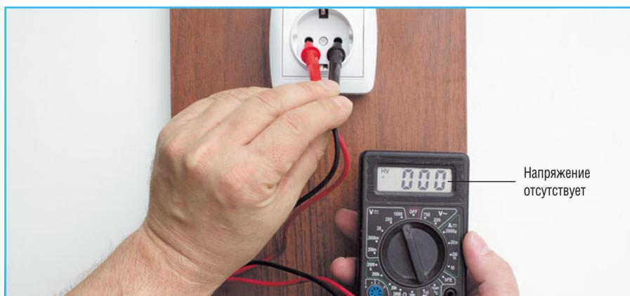
**5** Окончательно убеждаемся с помощью мультиметра в отсутствии напряжения. Прибор показывает: напряжения нет, но это не означает, что отсутствует фаза. При таких показаниях прибора фаза может быть, но оборван нулевой провод, поэтому проверка индикаторной отверткой надежнее.
