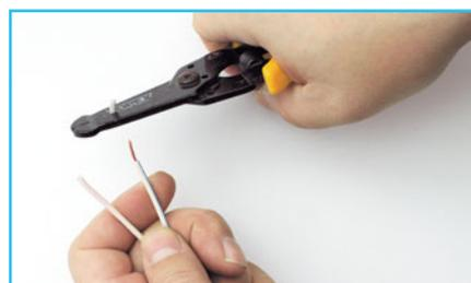
**8** Снимаем изоляцию с внутреннего провода.
