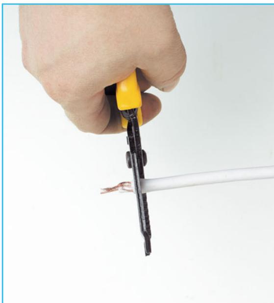
**1** **Отрезаем кабель**, чтобы центральный провод с экраном были на одном уровне.
