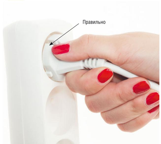
Чтобы достать вилку из розетки, нужно приложить усилие. Поэтому категорически недопустимо выдергивать вилку из розетки за шнур. Так вы быстро выведете штепсельное устройство из строя — произойдет обрыв проводников с последующим их замыканием внутри вилки. Починить ее сложно, а поскольку современные приборы все чаще оснащаются неразборными вилками, придется менять весь шнур питания электроприемника.
