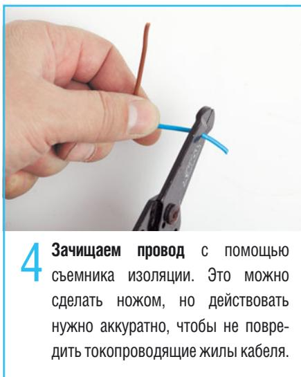
**4** Зачищаем провод с помощью съемника изоляции. Это можно сделать ножом, но действовать нужно аккуратно, чтобы не повредить токопроводящие жилы кабеля.
