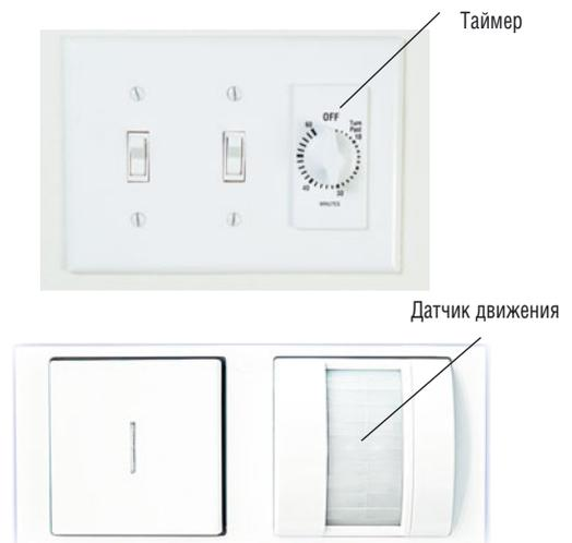
**Выключатель с таймером** оснащен часовым механизмом, который включает или отключает свет в заданное время. Вместе с ним можно устанавливать различные датчики, срабатывающие на звук, свет или движение. Иногда их монтируют прямо в корпус выключателя.
