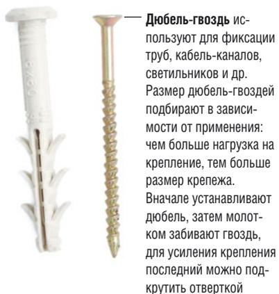
**Дюбель-гвоздь** используют для фиксации труб, кабель-каналов, светильников и др. Размер дюбель-гвоздей подбирают в зависимости от применения: чем больше нагрузка на крепление, тем больше размер крепежа. Вначале устанавливают дюбель, затем молотком забивают гвоздь, для усиления крепления последний можно подкрутить отверткой
