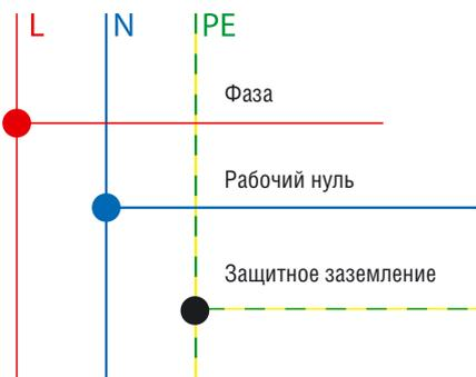
Схема однофазной цепи
