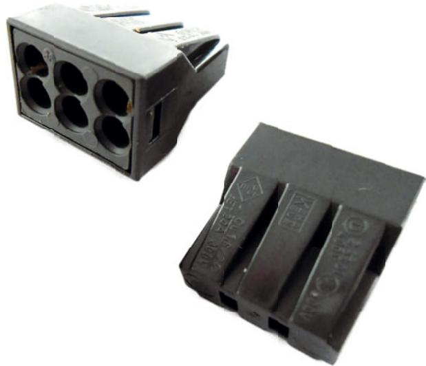
**Пружинные клеммы** — очень удобный вариант соединения, особенно медных и алюминиевых проводников. Концы жил оголяют и вставляют внутрь клеммы, где их фиксирует пружинный зажим.
