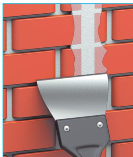
**6** Удаляем шпателем излишки смеси, выравнивая поверхность.
