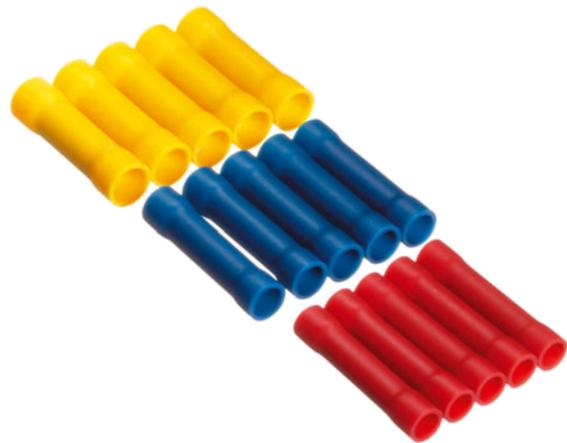
**Гильзованное соединение** выполняют с помощью специальных гильз, в которые зажимается провод. Опрессовку гильз делают специальными клещами. Надо следить, чтобы гильза соответствовала диаметру провода, который в нее зажимается. Обычно в клещах есть специальный фиксатор, который срабатывает, когда гильза зажата полностью.
