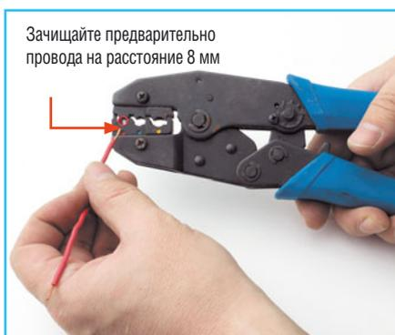
Зачищайте предварительно провода на расстояние 8 мм
