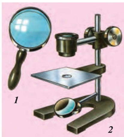
16-rasm. Lupalar: 1–qo‘l lupasi; 2–shtativli lupa.
