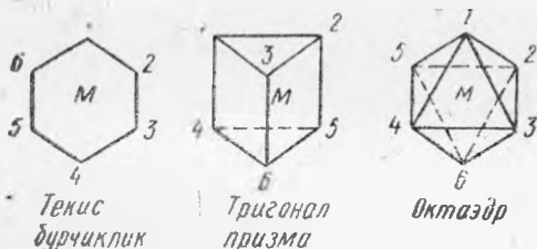
25-расм. Координацион сони 6 га тенг M комплекснинг тузилиши:
