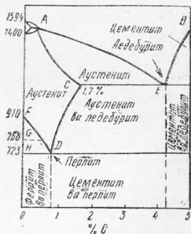
51-расм. Темир ва углерод системаси диаграммасининг Fe - Fe_3C қисми.
