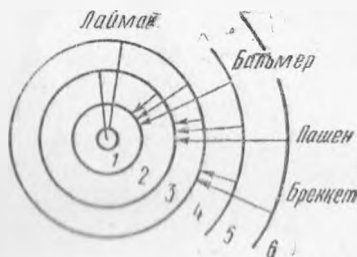
8-расм. Водород спектрининг ҳосил булиш схемаси
