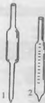
28-rasm. Pipetkalar: 1 – bir xil hajmli eritma uchun; 2 – har xil hajmli eritma uchun.
