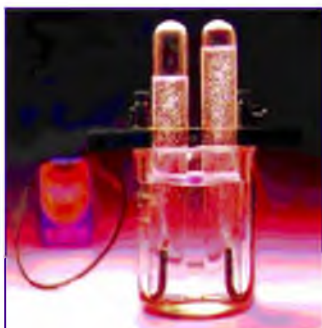
19-rasm. Suv elektrolizida 2 hajm vodorod va 1 hajm kislorod hosil bo‘ladi.
