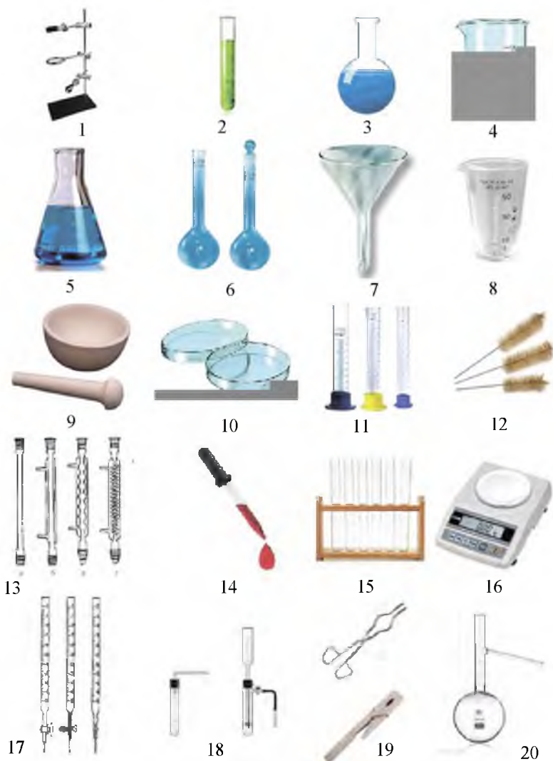
4-rasm. 1–universal shtativ; 2–probirka; 3–tubi yumaloq kolba; 4–oʻlchov stakani; 5–konussimon kolba; 6–oʻlchov kolbalari; 7–chinni voronkalar; 8–menzurka; 9–chinni hovoncha va dastasi; 10–Petri idishi; 11–oʻlchov silindrlari; 12–probirka tozalagich; 13–sovitkich; 14–pipetka; 15–probirka qoʻygich; 16–elektron tarozi; 17–byuretka; 18–gaz olish asbobi; 19–qisqichlar; 20–Vyurs kolbasi.
