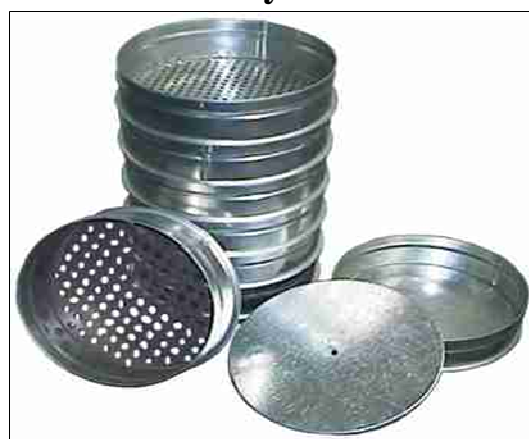
42-rasm. Tuproq donadorligini aniqlash uchun har xil o'lchamdagi elaklar to'plami
