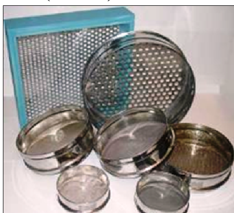
42-rasm. Tuproq donadorligini aniqlash uchun har xil o'lchamdagi elaklar to'plami
