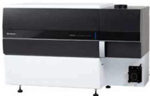
8-rasm. Induktiv – bog‘langan plazmalı optik emission spektrometr ICRE-9820
