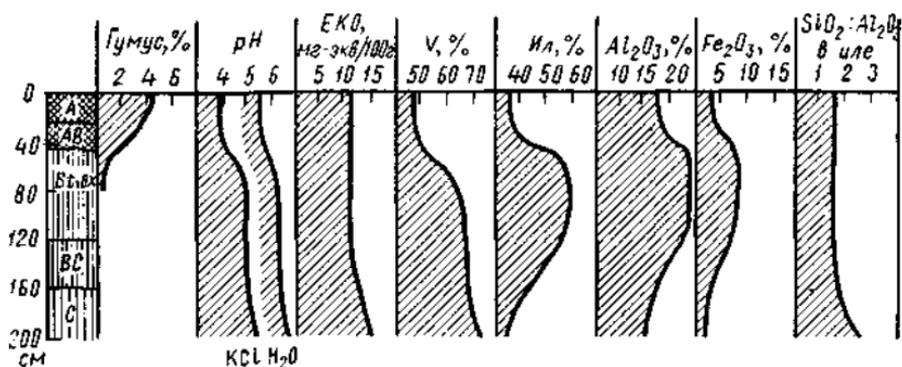
Рис. 57. Профильная характеристика ферралитной дифференцированной почвы
