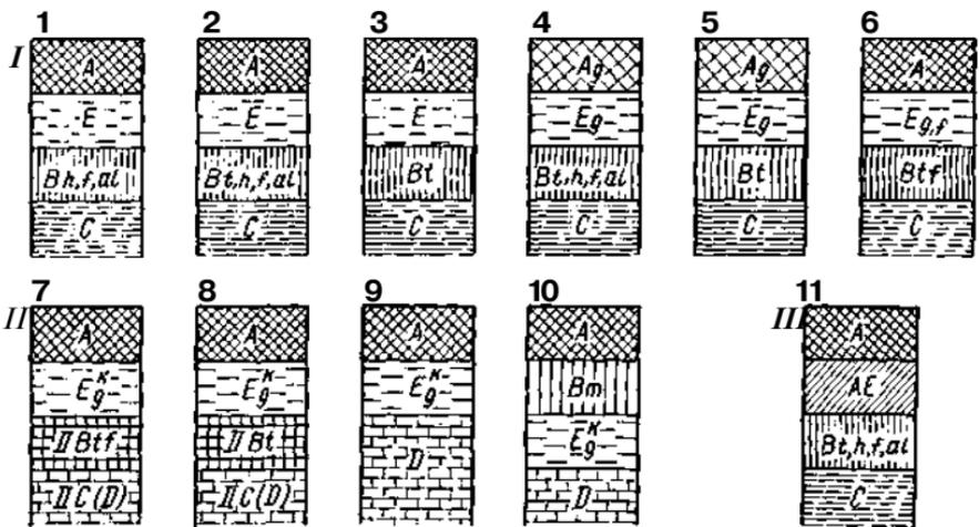
Рис. 21. Схемы строения разных типов элювиально-иллювиально-дифференцированных почв:
