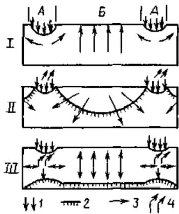
Рис. 18. Схема сезонного массо- и влагообмена в трещинно-нанопolygonальном почвенном комплексе тундровой гумусной глееватой почвы (А) и пятна (Б): I — почва мерзлая (поздняя осень, зима); II — весеннее оттаивание; III — максимальное оттаивание (конец лета); 1 — кустарничково-мохпвой растительный покров; 2 — уровень оттаивания мерзлоты; 3 — направление движения влаги и водорастворимых соединений; 4 — поверхностный сток или горизонтальное надмерзлотное элювирование
