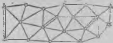
VI. 8- шакл. 1 ва 2 разряд триангуляция схемаси:
