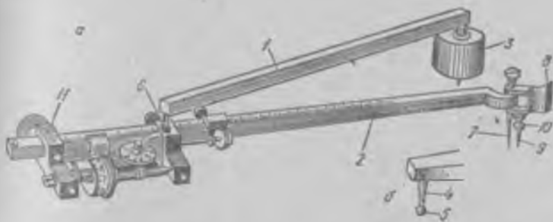
ХI. 15- шакл. Қутбли планиметр :
