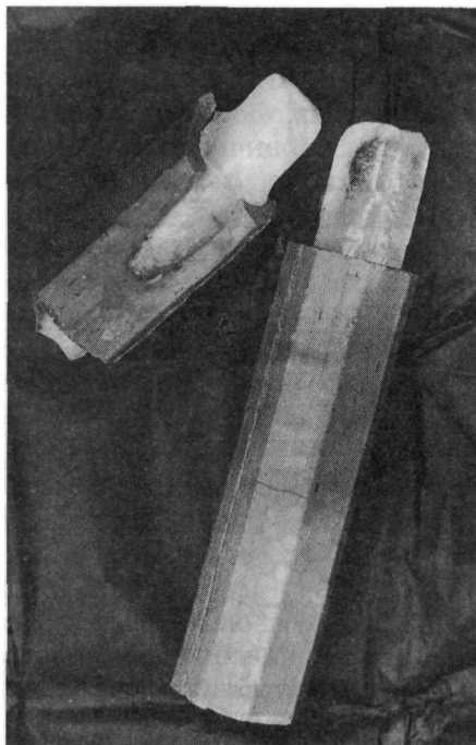
Рис. 111. Ледовые пробки в гончарных дренах осушительной системы на Убинской опытной станции. Барабинская низменность. Фото И.И. Логинова
