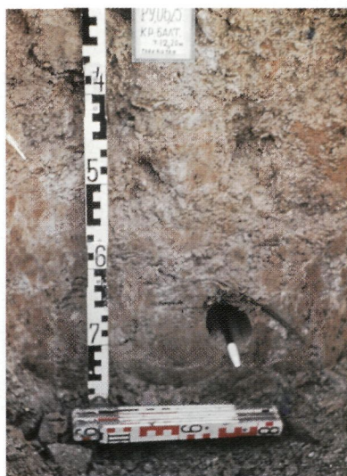
2.24 Кротовая ( земляная ) дрена в минеральных почвах. Московская обл.
