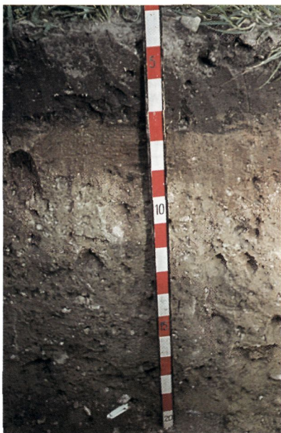
2.5 Красноцветные моренные суглинки, образованные в результате разрушения ледником красноцветных гранитов рапакиви
