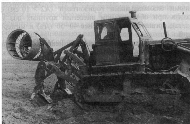
Рис. 136. Рыхлитель РУ 65.2,5 пассивного действия для одновременного глубокого мелиоративного рыхления (на глубину до 65 см) и кротования (на глубину до 75–80 см)
