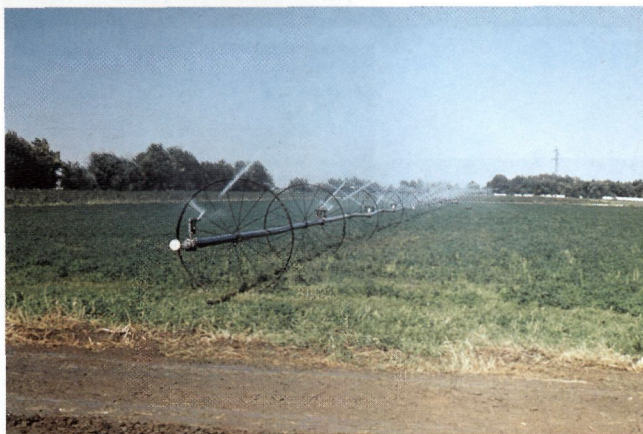
1.32 Орошение люцерны дождевальной машиной «Волжанка». Голодная степь. Узбекистан
