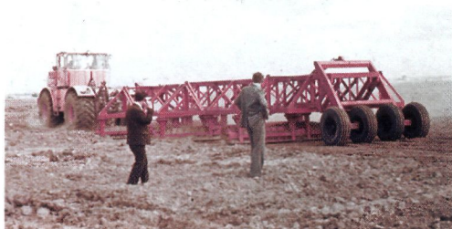
1.24 Планировка поверхности орошаемого массива длиннобазовым планировщиком
