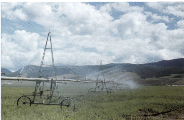
1.31 Полив люцерны дождевальной машиной «Фрегат», подключенной к гидранту. Бурятия
