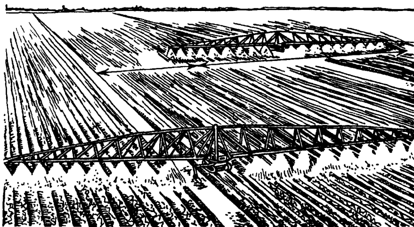
Рис. 70. Двухконсольный дождевальный короткоструйный агрегат ДДА-100МА
