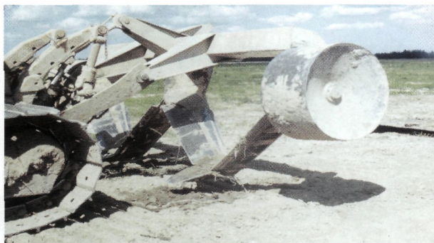
2.44 V-образный рыхлитель пассивного действия конструкции ВНИИГиМ
