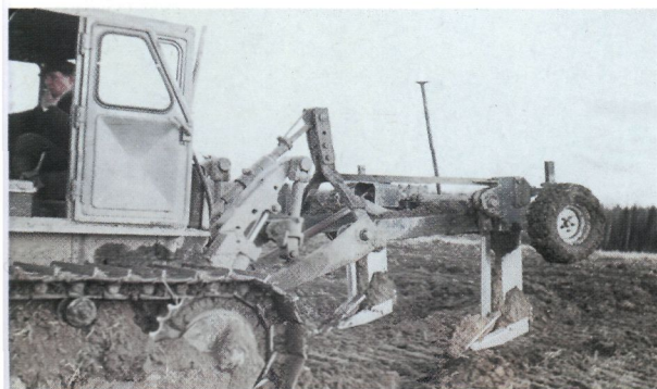
2.45 Двухкорпусный рыхлитель активного действия фирмы "Брениг". Рыхление на глубину 80 см
