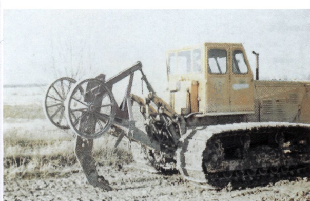
2.43 Однокорпусный рыхлитель-кротователь пассивного действия. РК-1.2
